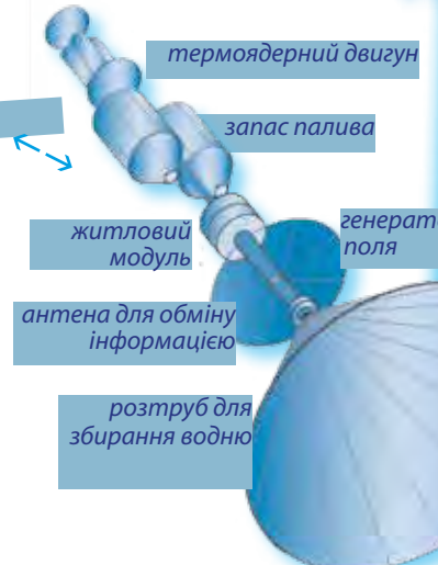
Ракета з прямоточним термоядерним двигуном. Мал. Джеффі Ворда (Jeffrey L. Ward)
